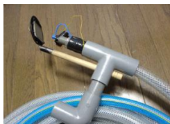
水中で測定するため10mのファイバーを用いた
